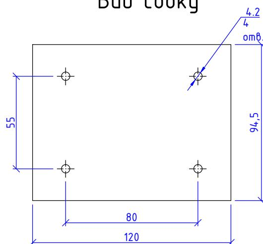
Сталь 08пс, 12Х18Н10Т (AISI 321), 08Х18Н10Т (AISI 304), 12Х17 (AISI 430)
