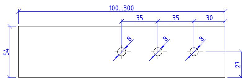
Сталь 08пс, 12Х18Н10Т (AISI 321), 08Х18Н10Т (AISI 304), 12Х17 (AISI 430)
