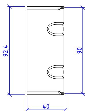
Сталь 08пс, 12Х18Н10Т (AISI 321), 08Х18Н10Т (AISI 304), 12Х17 (AISI 430)
