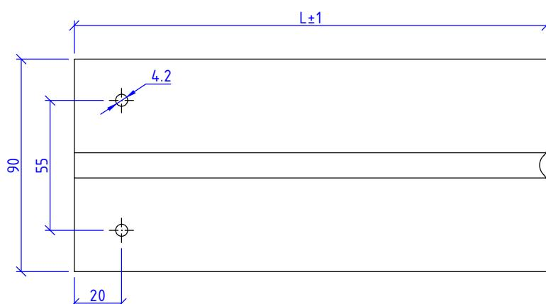
Сталь 08пс, 12Х18Н10Т (AISI 321), 08Х18Н10Т (AISI 304), 12Х17 (AISI 430)
