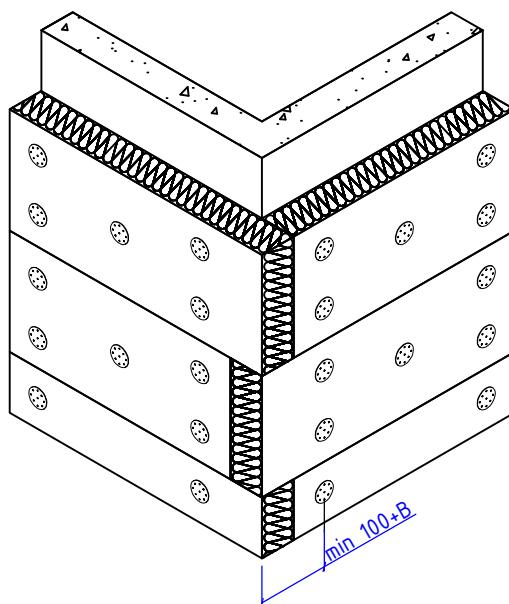
1. Крепление теплоизоляционных плит к стене осуществляется
